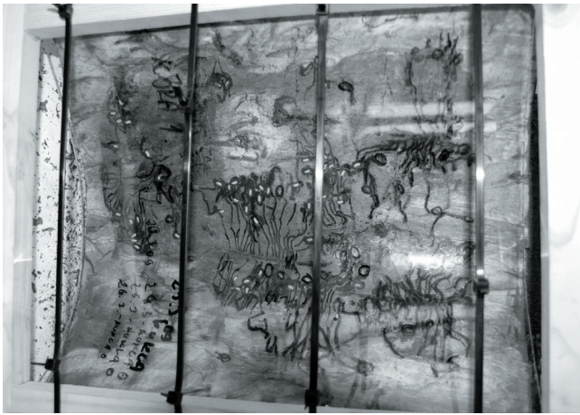
Obr. 2. Priehľadné plexisklo umožňuje vizuálnu kontrolu vývinu požerokov (vpravo)
